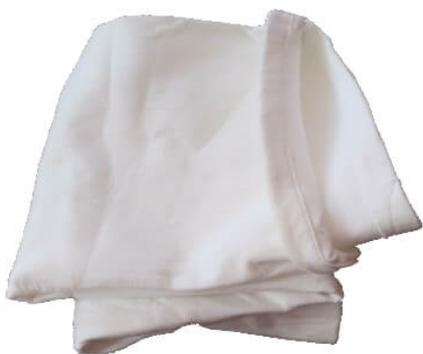
Рукавный фильтр АЛВГ-Ф11.001.00.00-04 марка А (М33) для пылеулавливающих агрегатов УВП в исполнении [УВП-2000](#), УВП-3000, УВП-5000, УВП-7000 производства ЗАО "Консар" г. Саров. Размер 530x1150 мм. Данный тип фильтра также подходит для снятых с производства пылеуловителей УВП-1500, УВП-2500 производства ЗАО "Консар". Площадь фильтрования 2,1м2. Степень очистки не менее 99%.
